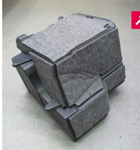
Nahezu komplette Umschließung des Außenstaufachs mit Dämmmatten
