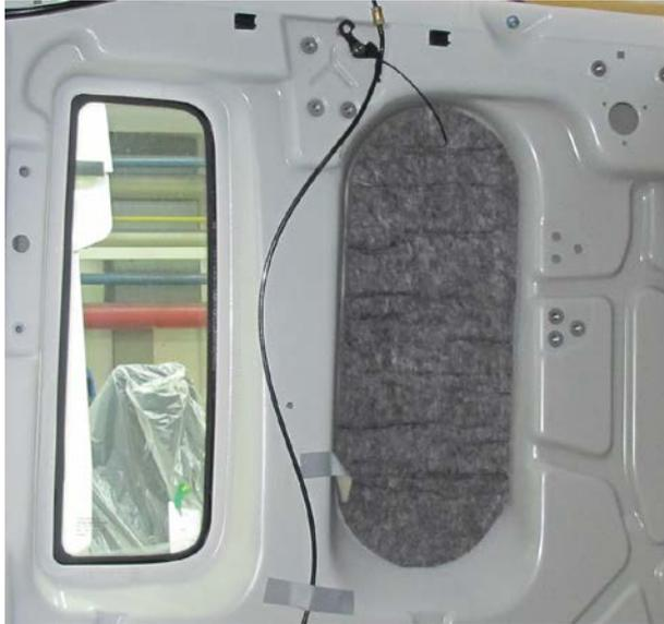
Dämmmatten im Bereich der Seitenwand
