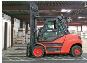
Auch zwei neue Hochregalstapler sind im Einsatz. Diese wurden erstmals mit einem Kamerasystem an den Zinken ausgestattet, um die Ein- und Auslagerungen aus den bis zu 10m hohen Regalen sicherer zu gestalten.
